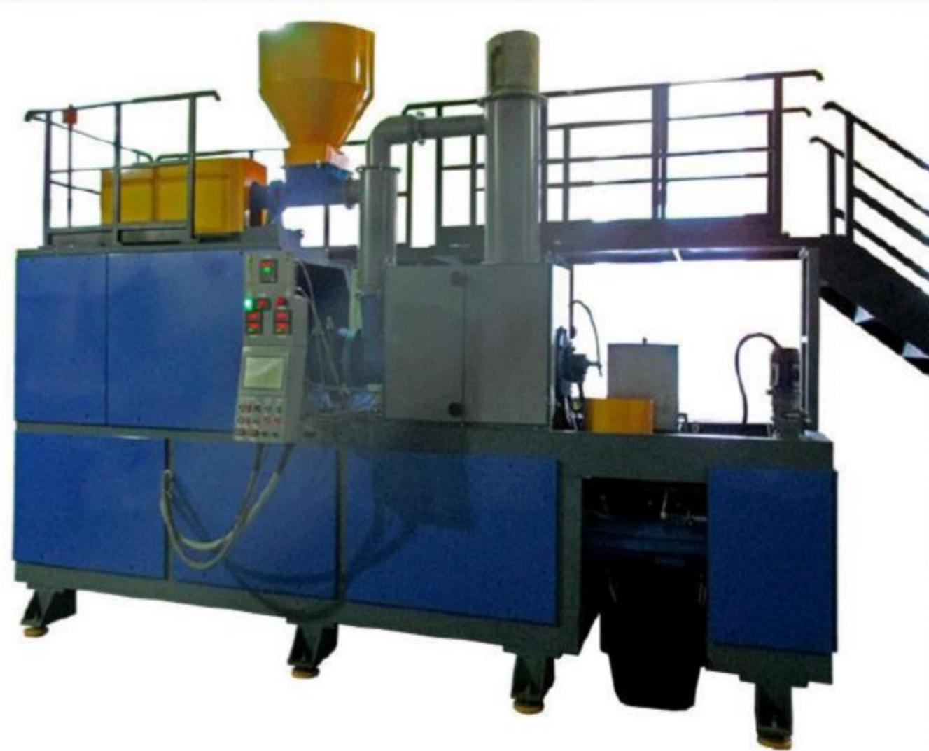
Оборудование предназначено для переработки резиновой крошки фракции 2-4 мм в модифицированный регенерат, производительностью 100 и 200 кг/час.
